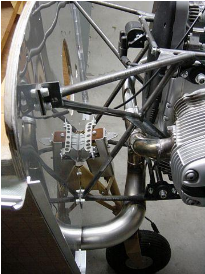
Die 75 mm Rohrbögen sollen als eine Art Mitteltopf dienen
